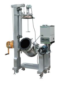
ニーズに合わせて設計、製作します。 タンクの蓋を昇降、タンク本体を反転 タンク内面テフロンコーティング 循環 式ポンプ付き恒温槽とセッティング
