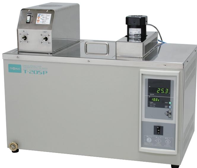
槽内用攪拌があり、熱媒体を送り込む前に、35Lの槽の熱媒体を事前に一定温度に上げておくことができます。
