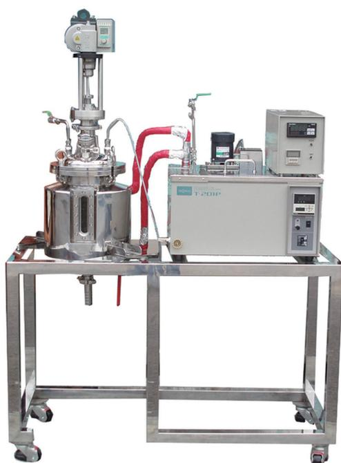
ラボスケール、小容量 (5L) の溶液を加熱制御するのに最適です。
