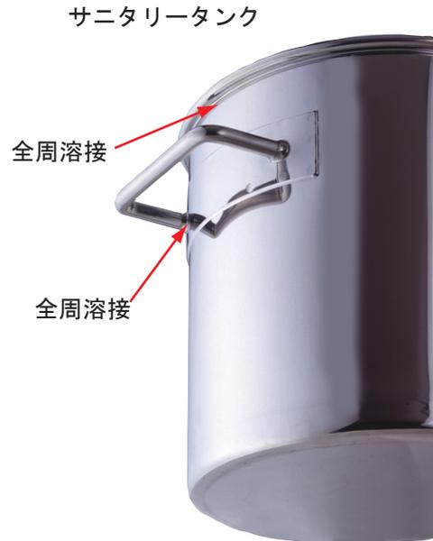
タンクの内側のカーブ部分を全周溶接溶接してコンタミが溜まらないようにしてあります。取っ手は、丸棒を使用し、溶接部は、全周溶接し、仕上げています。
